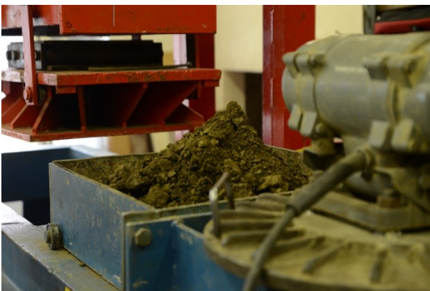
Obr. 3.: Velkoformátová smyková zkouška v laboratořích GEOTest a.s.
